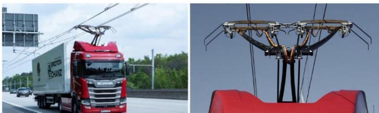
La solution conductive aérienne est une solution dérivée des lignes ferroviaires appliquée à la route. Une ligne aérienne de contact, appelée caténaire, alimente en énergie le véhicule par l'intermédiaire d'un pantographe par frottement. Comme la chaussée ne peut pas être utilisée comme conducteur de retour électrique, le système de ligne aérienne de contact et le pantographe sont électriquement bipolaires (deux lignes de caténaire et deux pantographes).
